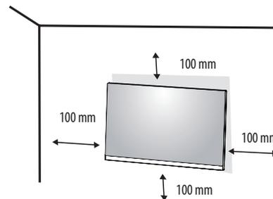
Para instalar o monitor numa parede, fixe um suporte de montagem na parede (opcional) à parte posterior do monitor.
