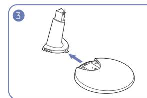
Retire o conector da base puxando-o na direcção da seta, conforme ilustrado na figura.
