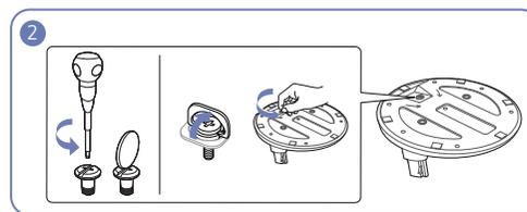
Rode o parafuso de ligação existente na parte inferior da base para separá-la.
