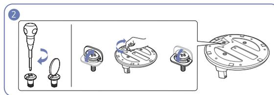
Rode o parafuso de ligação existente na parte inferior da base até este ficar totalmente fixo.
