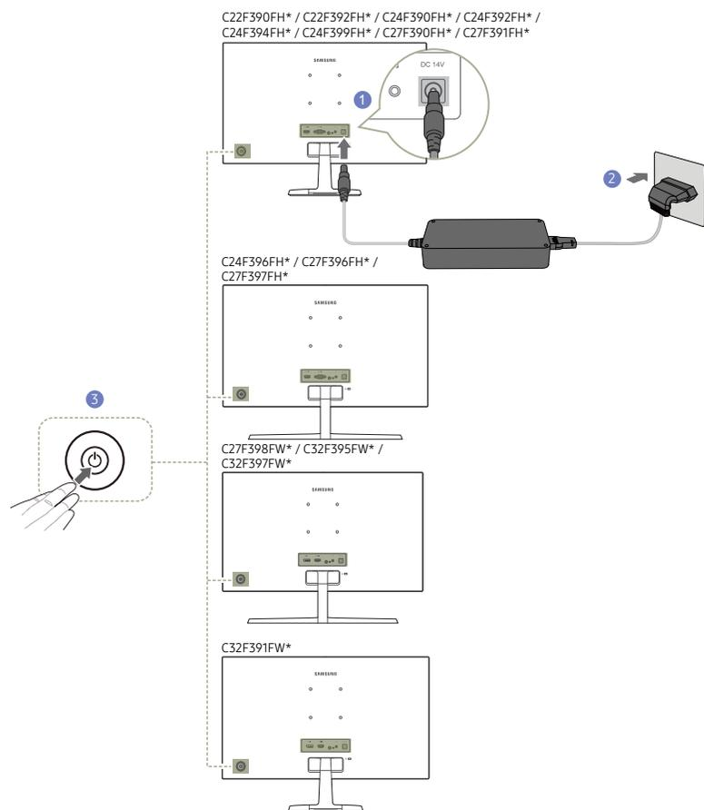
1 Ligue o cabo de alimentação ao transformador de CA/CC. Em seguida, ligue o transformador de CA/CC à porta DC 14V na parte traseira do produto.
