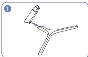
Introduza o conector na base, na direcção ilustrada pela figura.
