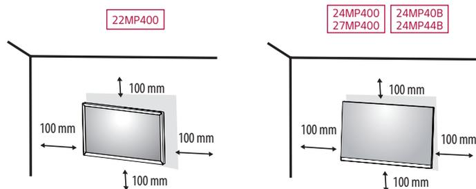
Para instalar o monitor numa parede, fixe um suporte de montagem na parede (opcional) à parte posterior do monitor.
