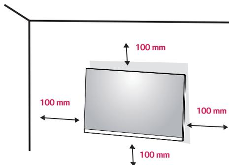
Para instalar o monitor numa parede, fixe o suporte de montagem na parede (opcional) a parte posterior do monitor.
