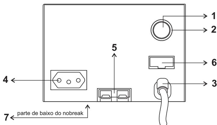
1 - Chave Liga-desliga Utilizada para colocar o Nobreak em funcionamento. Para evitar acionamento acidental, esta chave possui um temporizador para evitar o desligamento acidental.
