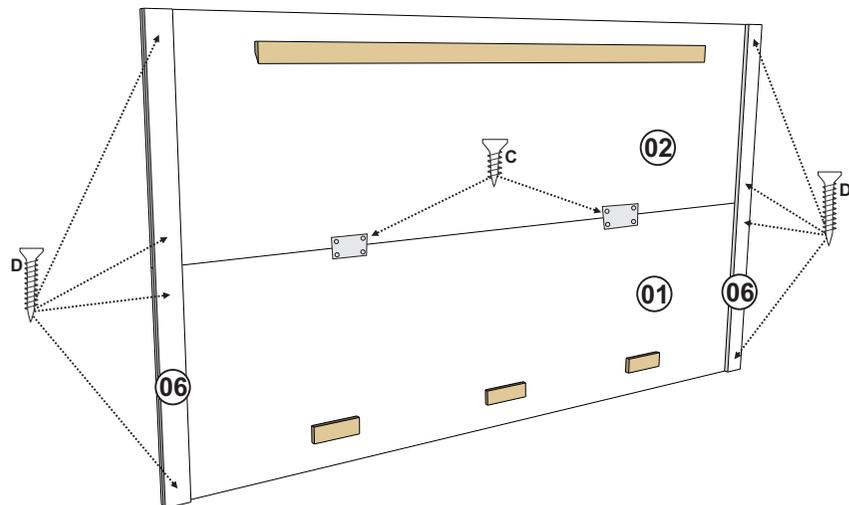
Fixar as peças 06 nas peças 01 e 02 com Parafuso 3,5x20. Fixar as Chapinha de Ferro com Parafuso 3,5x12 para unir os painéis 01 e 02.
