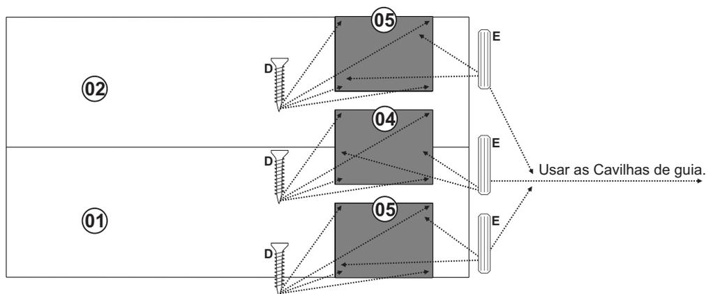
Usar as Cavilhas como guia para fixar as peças 05 e 04 na peça 01 e 02. Depois fixar por traz do Pannel com Parafuso 3,5x20.
