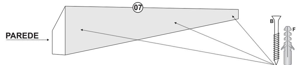
Fixar o Suporte de Pannel na parede com 3 Parafusos 6x60 e 3 buchas 10.
