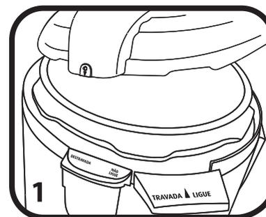
Coloque a tampa da sua panela na posição correta de encaixe e gire-a no sentido anti-horário até a posição "TRAVADA LIGUE".
