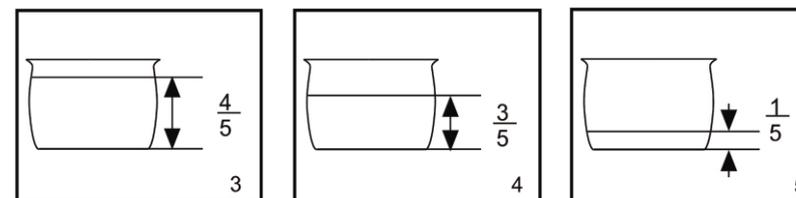
4. O conteúdo não deve ultrapassar a marca 4/5 indicada (fig. 3, abaixo) no interior do recipiente e também não pode ser inferior à marcação de 1/5 (fig. 5, abaixo). No caso de alimentos que crescem durante o cozimento, não se deve ultrapassar a marca de 3/5 (fig. 4, abaixo) indicada no interior da panela.
