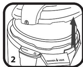
2. Instalação da Cuba Antiaderente. Para retirar ou colocar a Cuba Antiaderente (5) no interior do aparelho, segure-a pelas bordas e ajuste-a bem no interior, para garantir um contato perfeito com a Placa de Aquecimento (15).
