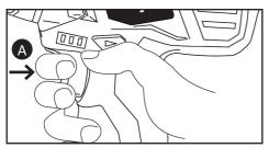
Pressionando o interruptor a ferramenta liga (A), a rotação aumenta conforme pressionar mais o interruptor.
