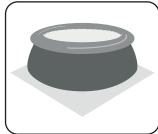
Comece a encher a piscina. Quando a água atingir um palmo de altura, elimine as rugas do fundo da piscina, na direção do centro para as bordas das paredes da piscina. Esta operação é muito importante para assegurar que a piscina esteja bem montada. IMPORTANTE: encha a piscina somente até a medida indicada na caixa.
