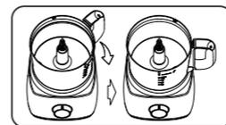
•Coloque o adaptador das lâminas na haste.
