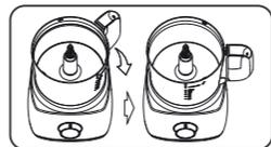
•Encaixe o filtro do espremedor sobre a jarra e gire 30° em sentido horário para encaixar, depois encaixe o cone.
