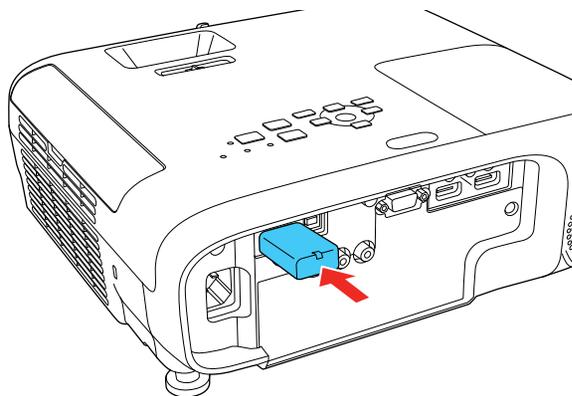
3. Encaixe a tampa do módulo de LAN sem fio e prenda-a usando o parafuso removido.
