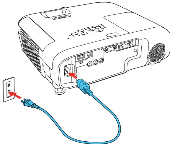
3. Conecte o cabo de alimentação a uma tomada elétrica.
