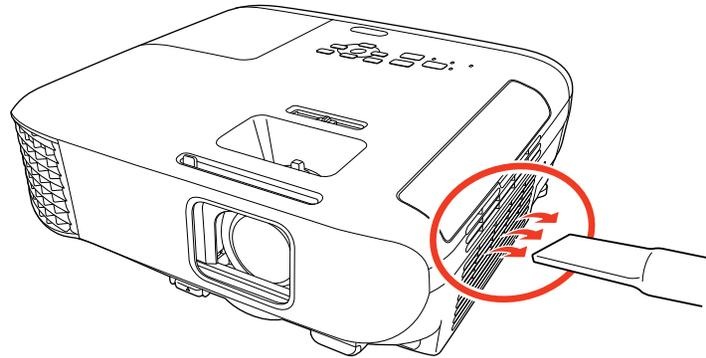
**Observação:** Você pode remover o filtro de ar para limpar os dois lados dele. Não lave o filtro de ar com água ou use qualquer detergente ou solvente para limpá-lo.
