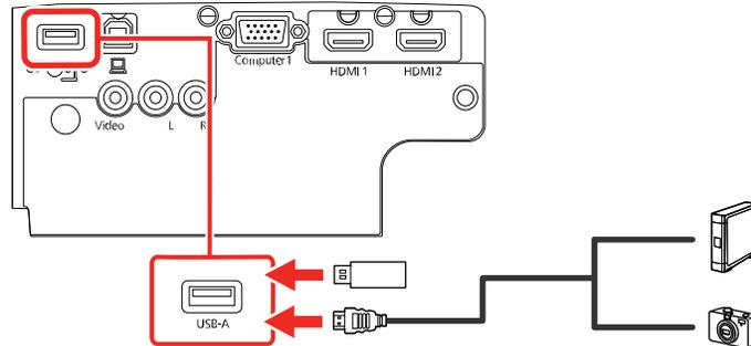
**Observação:** Não conecte um hub USB ou um cabo USB com mais de 3 metros; o dispositivo pode não funcionar corretamente.
