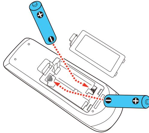
**Alerta:** Certifique-se de que as pilhas estejam inseridas na posição correta. Se as pilhas não forem inseridas corretamente, elas podem explodir ou vazarem, causando incêndio, ferimento ou danos ao produto.
