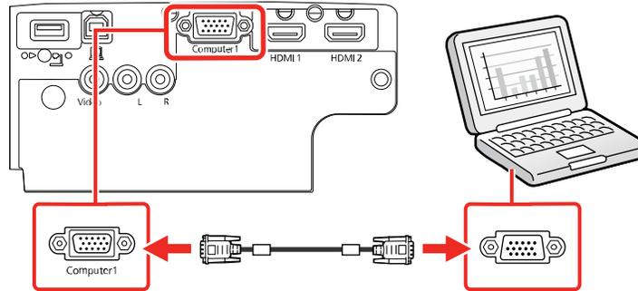
4. Aperte os parafusos do conector VGA.
