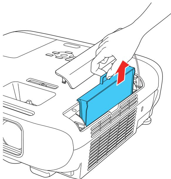
**Observação:** Os filtros de ar contêm resina ABS e espuma de poliuretano. Desfaça-se dos filtros de ar usados de acordo com as regulamentações locais.
