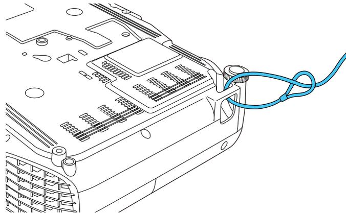
**Observação:** Não passe cabos de prevenção de queda pelo ponto de fixação do cabo de segurança, quando montar o projetor em uma parede ou no teto.
