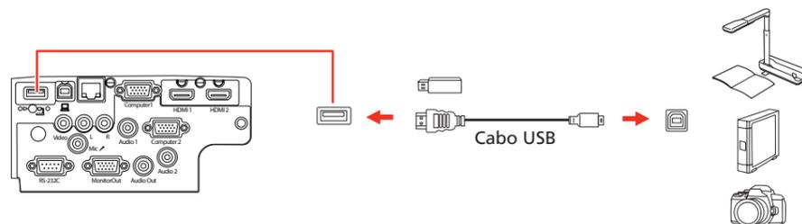
Se conectar uma câmera digital, um flash drive USB ou um dispositivo de armazenamento USB, você pode usar a função PC Free do projetor. Veja o *Manual do usuário* online para detalhes.
