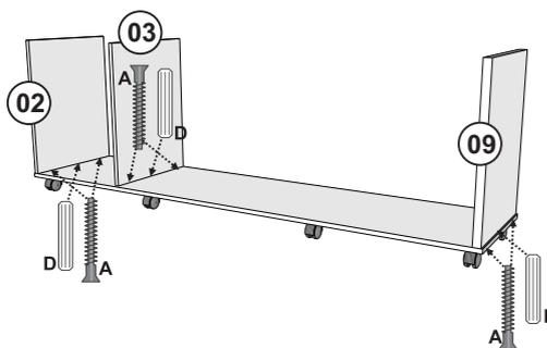
Fixar as peças 02, 03 e 09 na peça 01 com Parafus 5x40 e Cavilha.
