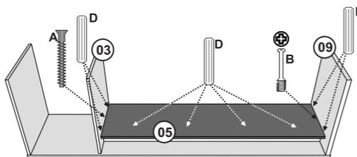
Fixar a peça 05 na Régua 04 com Cavilha; na peça 03 com Cavilha e Parafuso 5x40; e na peça 09 com Cavilha e Mini Fix.
