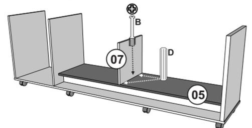
Fixar a peça 07 na peça 05 com Cavilha e Mini Fix.
