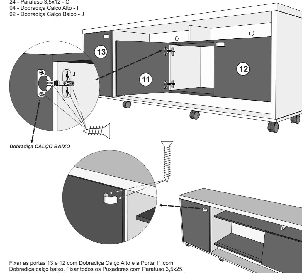
Fixar as portas 13 e 12 com Dobradiça Calço Alto e a Porta 11 com Dobradiça calço baixo. Fixar todos os Puxadores com Parafuso 3,5x25.
