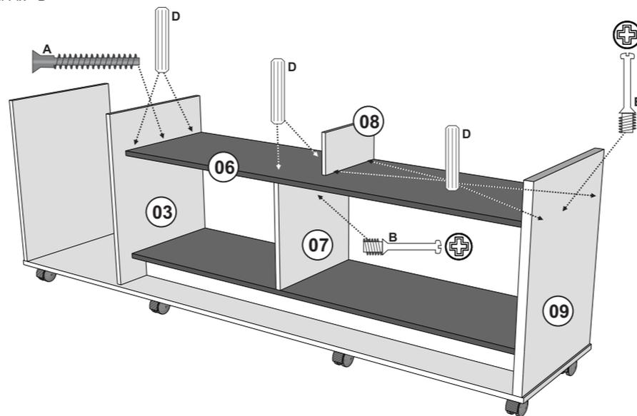
Fixar a peça 06 na peça 03 com Cavilha e Parafuso 5x40, na peça 07 com Cavilha e na peça 09 com Mini Fix e Cavilha. Fixar a peça 08 na peça 07 com Cavilha.
