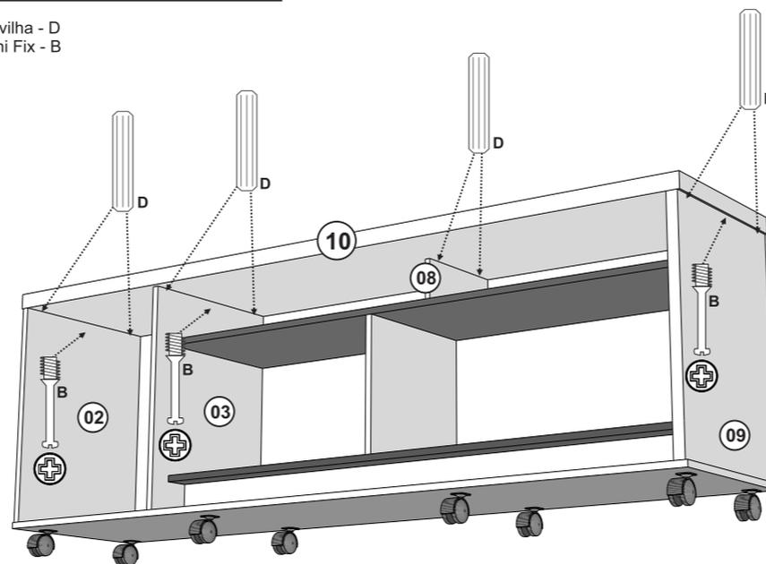
Fixar o Tampo 10 na peça 02, 03 e 09 com Cavilha e Mini Fix e na peça 08 apenas com Cavilha.
