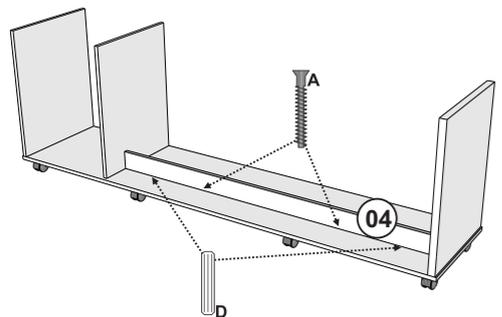
Fixar a peça 04 na peça 01 com Cavilha e Parafuso 5x40.
