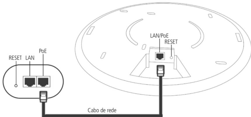
2. Conecte uma das extremidades de outro cabo de rede à porta LAN do adaptador PoE e a outra extremidade à porta LAN de seu computador ou de outro dispositivo, de acordo com a necessidade;
