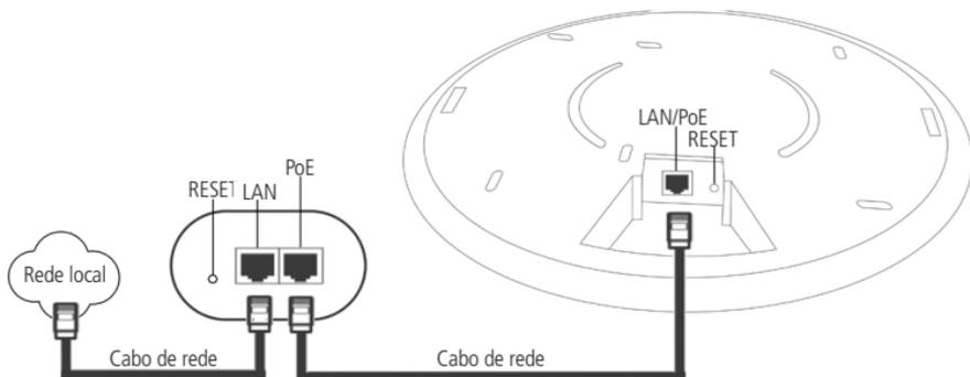
3. Conecte o cabo AC ao adaptador PoE e em seguida ligue-o na tomada elétrica 110/220 V. O LED acenderá.
