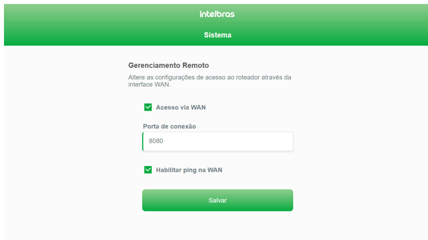
Tela de gerenciamento remoto com opção Acesso via WAN habilitada
