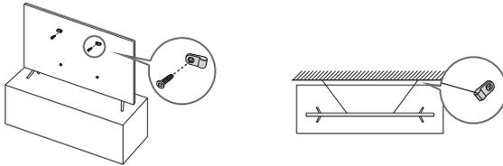
1. Utilizando os parafusos apropriados, fixe firmemente o conjunto de suportes na parede. Verifique se os parafusos estão bem presos à parede.
