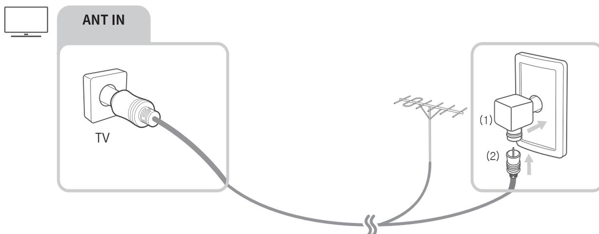
Conecte o adaptador de antena fornecido a um terminal de antena, então conecte o cabo da antena, que está conectado à ANT IN na TV, ao adaptador de antena.
