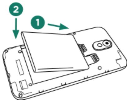
**B.** Una os contatos metálicos da parte superior esquerda da bateria alinhados com os contatos metálicos do compartimento(1) e então pressione a parte inferior da bateria, junto ao compartimento até que haja um encaixe(2). Para finalizar, recoloque a tampa do aparelho, pressionando novamente toda a extensão das arestas da tampa.
