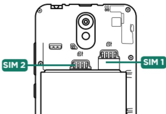
Para inserir Cartões SIM (telefonia), primeiro desligue o aparelho e remova a bateria. Em seguida, localize o encaixe do cartão que deseja inserir. Seu aparelho suporta 2 cartões SIM. Micro SIM (1) / Nano SIM (2).
