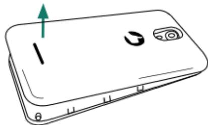
**A.** Para retirar a tampa, é necessário puxá-la através do chanfro no canto inferior esquerdo e posteriormente desencaixar os demais cantos. Faça com que a tampa se solte do aparelho aos poucos.
