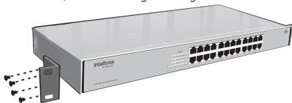
Fixação dos suportes em "L"
