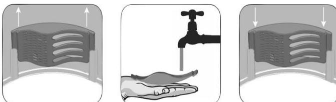
Deslize para cima Para remover o Retentor de fiapos. Lave o retentor de Fiapos. Deslize para baixo Para encaixar o Retentor de fiapos.
