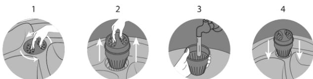
Gire a tampa do retentor de fiapos no sentido anti-horário. Segure a tampa e puxe, o filtro virá junto. Separe o filtro da tampa, e higienize-o dos fiapos. Reencaixe a tampa no filtro e insira de volta no turbilhonador. Gire no sentido horário para travar.
