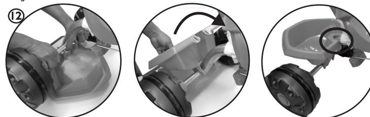
12 - Apoiada em uma superfície, coloque a caçamba virada para baixo, pressione e encaixe as duas travas no quadro, entre as duas rodas traseiras. Gire a caçamba para cima e encaixe-a no quadro. **A caçamba traseira possui um sistema basculante.**
