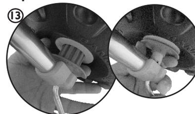
13 - No lado direito da roda dianteira, (considere o lado direito como se estivesse sentado no triciclo) puxe a trava para ativar o "dispositivo roda livre" Para desativar o "dispositivo roda livre", pressione novamente a trava encaixando-a na roda.
