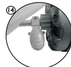
14 - Para acionar o freio, pressione o pedal do freio para baixo para frear o triciclo. Para colocar o triciclo em movimento, faça a operação inversa.
