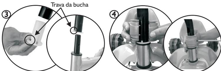
3 - Encaixe a bucha no guidão alinhando a trava da bucha no encaixe do guidão, em seguida insira o quadro no garfo e no final insira o guidão, de modo que o furo do guidão alinhe com o furo do garfo.
