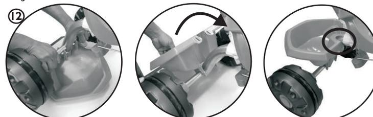
12 - Apoiada em uma superfície, coloque a caçamba virada para baixo, pressione e encaixe as duas travas no quadro, entre as duas rodas traseiras. Gire a caçamba para cima e encaixe-a no quadro.
