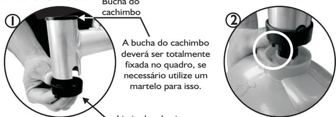
1 - Encaixe o limitador de giro e a bucha do cachimbo no quadro, conforme a imagem acima.
