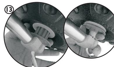
13 - No lado direito da roda dianteira, (considere o lado direito como se estivesse sentado no triciclo) puxe a bucha para ativar o "sistema de roda livre". Para desativar o "sistema de roda livre", pressione novamente a bucha encaixando-a na roda.
