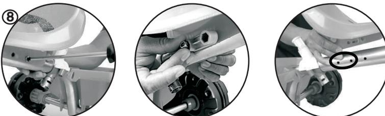
8 - Conforme imagem acima, encaixe o assento em cima do quadro e alinhe os furos laterais do quadro com os furos na parte de baixo do assento. Para fixar o assento no quadro, insira as duas porcas na trava das porcas, coloque-a alinhada no furo do assento já encaixado no quadro e fixe-o com dois parafusos com o auxílio da chave philips.
