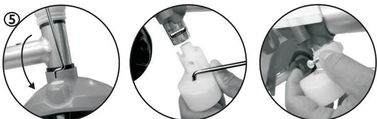
5 - Encaixe a haste de direção na bucha localizada no para-lama da roda dianteira, primeiro na vertical e gire a haste no sentido horizontal para encaixar.
