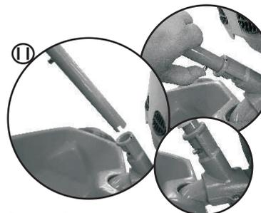
11 - Encaixe a haste na bucha superior da trava de haste, que está localizada no quadro, conforme imagem ao lado. Para fixar, pressione o pino mola até que ele passe pela bucha superior da trava da haste e fique encaixado no furo correspondente.
