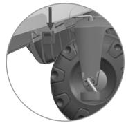
4.2- Para remover: Pressione a trava do apoio (dir/esq) localizada na área inferior do corpo do produto e remova.
