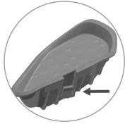
4.1- Para fixar: Posicione a trava do apoio (dir/esq) encaixando no alojamento do corpo e pressione para encaixar. Certifique-se que esteja encaixado corretamente.
