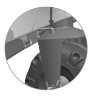
1.2- Encaixe eixo direcionador no orifício do garfo.
