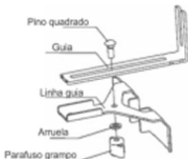
Fig. 5 – Fresando com guia reta
