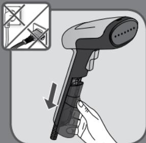
Remova o tanque d'água deslizando-o para baixo.
