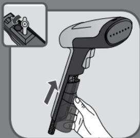
Recoloque o depósito de água em seu lugar no aparelho. Certifique-se de que o depósito de água está devidamente encaixado.
