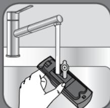
Encha o tanque d'água com no máximo 70ml de água corrente (em caso de dúvidas consulte o capítulo "Que água utilizar?")
