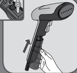
Recoloque o depósito de água em seu lugar no aparelho. Certifique-se de que o depósito de água está devidamente encaixado.
