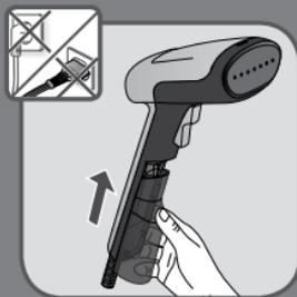
Recoloque o tanque de água no seu lugar, deslizando-o para cima até ficar completamente encaixado. Certifique-se de que o tanque de água está devidamente encaixado.
