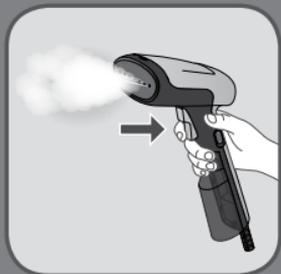
Pressione o botão de vapor com a saída de vapor virada para longe de si, mantendo-o na posição vertical.
